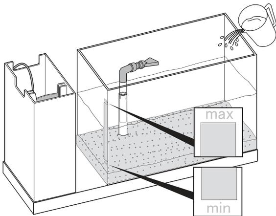
1. 水槽側面に表示している水位線のMINとMAXの中間位に水位がくるように、水槽側に水を入れる。
